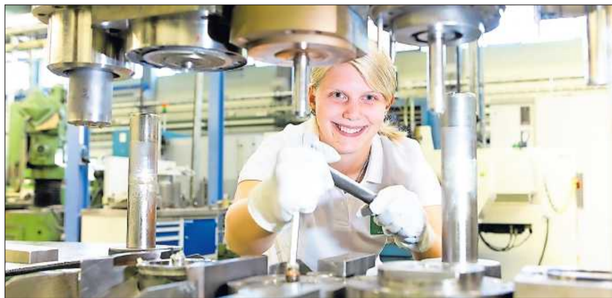
Die Mann+Hummel-Marke Mann-Filter ist besonders bekannt. Hier montiert eine Mann+Hummel-Werkzeugmechanikerin ein Folgewerkzeug zur Deckelfertigung. Solche Deckel werden beispielsweise auf Luftfilter für Autos aufgesetzt. FOTO: MANN+HUMMEL/FREI
